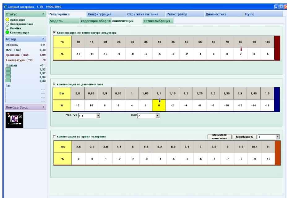
**Компенсация разницы температур редуктора** помогает удержать оптимальную смесь, когда двигатель находится в фазе нагрева или, когда температура газа растёт выше нормы: - сразу же после переключения после длительной стоянки, когда двигатель ещё не разогрелся, а температура газа низкая, и его плотность большая включённая компенсация предотвращает чрезмерное обогащение смеси время открытия газовых инжекторов сокращается, например, при Тред. = 30 на 4%.
