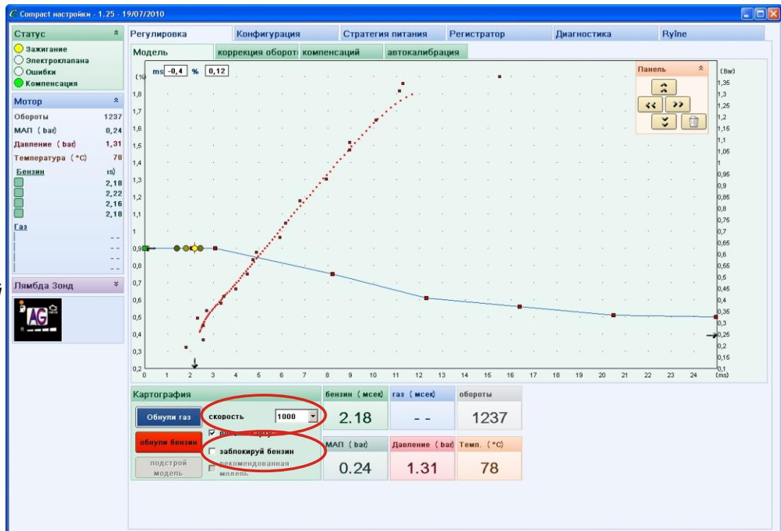
**После создания бензиновой карты следует переключить питание на «газ» и создать газовую карту. Когда линия газовых точек (голубого цвета) полностью совпадёт в полном диапазоне нагрузки с линией бензиновых точек (красного цвета), то регулировка будет завершена.**
