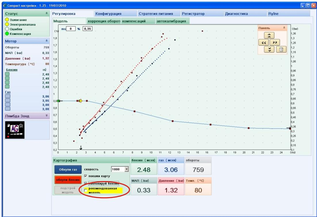
*В поле графика появляются зелёные точки, которые показывают, как должна выглядеть модель для того, чтобы бензиновая и газовая карта совпали. В это время следует произвести корректировку модели. Можно это сделать двумя способами: применяя автоматическую функцию «Приспособь модель» или вручную. Если выберем ручную регулировку, то следует «подтянуть» отдельные регулировочные точки из модели, вести линии модели как можно ближе зелёных точек, плавно, без резких изгибов.*
