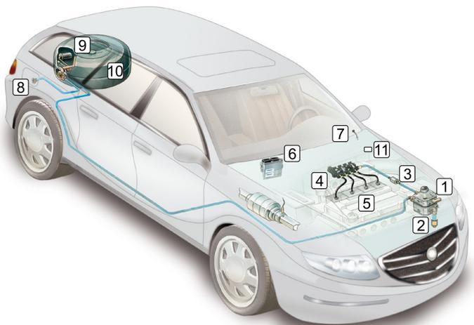
**1 Регулятор давления** – снижает давление газа, находящегося в жидком состоянии в баллоне, до такого уровня, при котором он переходит в газообразное состояние, и которое подходит для инжекторов газа. Регулятор оснащен газовым фильтром для жидкого газа и предохранительным электромагнитным клапаном.
